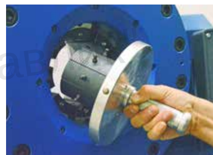
3. Вставьте инструмент с насадкой в пресс
