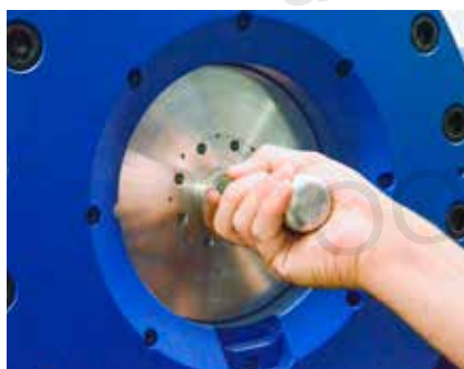
4. Закройте пресс, чтобы зафиксировать насадку
