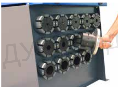
2. Поверните и вытащите инструмент с насадкой (штампом)
