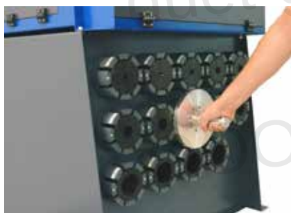
1. Вставьте инструмент "Сменник-1" в выбранную насадку (штамп)
